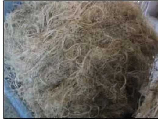
La cardatura: l'operazione che trasforma la stoppa di fibra macerata in "**nastro cardato**", nel quale le fibre sono disposte distese e orientate secondo l'asse longitudinale del nastro.
